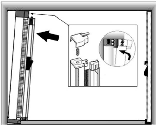
**7 c:** Inserire la guida superiore, infine bloccare la zanzariera tramite i tappi a espansione.
